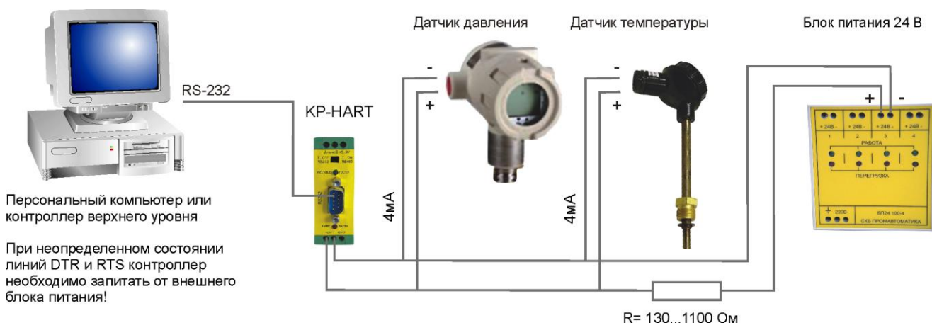
Рис.2.Схема соединения датчиков, контроллера (с использованием выхода RS-232) и ПК (контроллера верхнего уровня)
